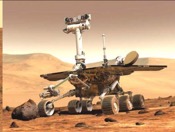
Die Raumsonde Spirit ist auf dem Mars, um dort nach Leben zu suchen. Dazu wurde sie als Roboterfahrzeug (Rover) konstruiert, das verschiedene Gesteinsstrukturen erkunden und analysieren kann. Aus eigenem Antrieb kann der Rover Steigungen bis zu 35 Prozent bewältigen.
