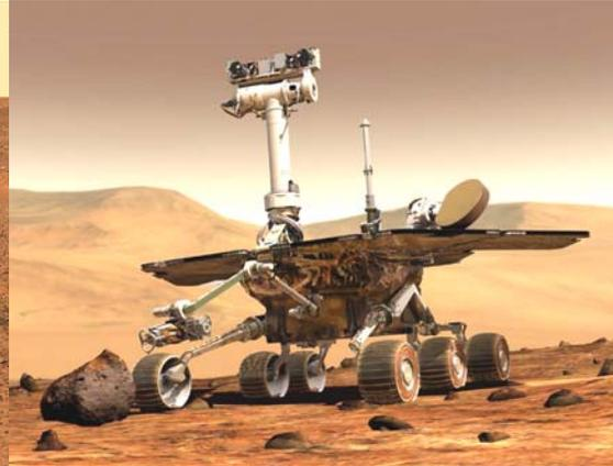
Die Raumsonde Spirit ist auf dem Mars, um dort nach Leben zu suchen. Dazu wurde sie als Roboterfahrzeug (Rover) konstruiert, das verschiedene Gesteinsstrukturen erkunden und analysieren kann. Aus eigenem Antrieb kann der Rover Steigungen bis zu 35 Prozent bewältigen.
